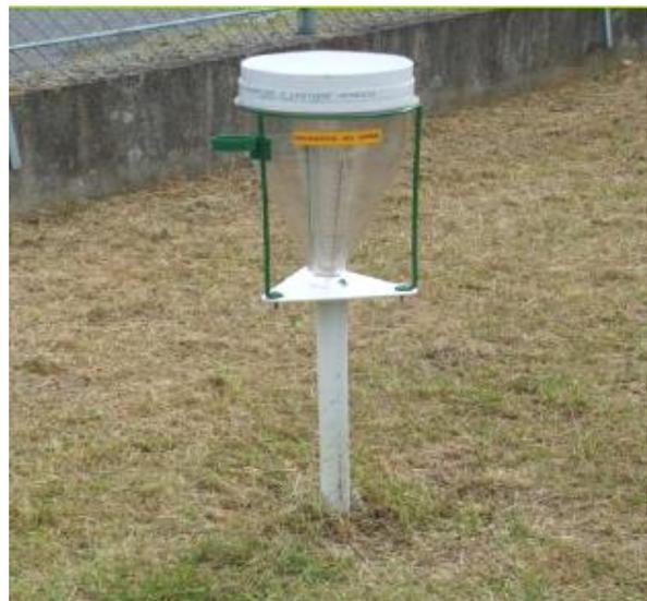
**Figure 21** - pluviomètre 0,04 m<sup>2</sup> à lecture directe
