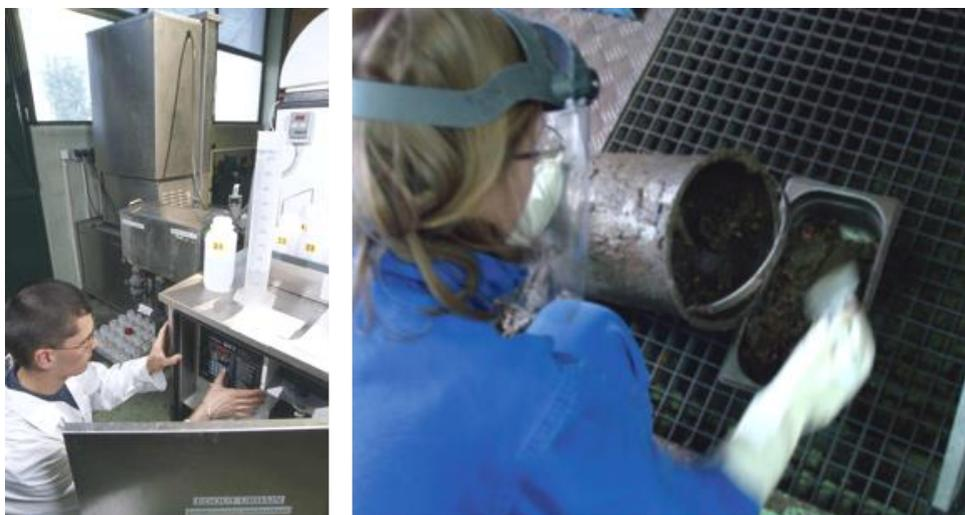
**Figure 4** - Surveillance en continu des émetteurs  $\beta\gamma$  de l'égout urbain et prélèvement de boues
