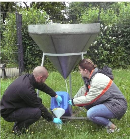
**Figure 20** - Pluviomètre 1 m<sup>2</sup>
